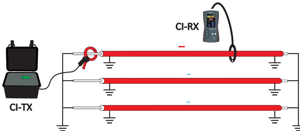
A través de la inyección polarizada de una frecuencia de señal, es posible identificar positivamente cables sin tensión.
