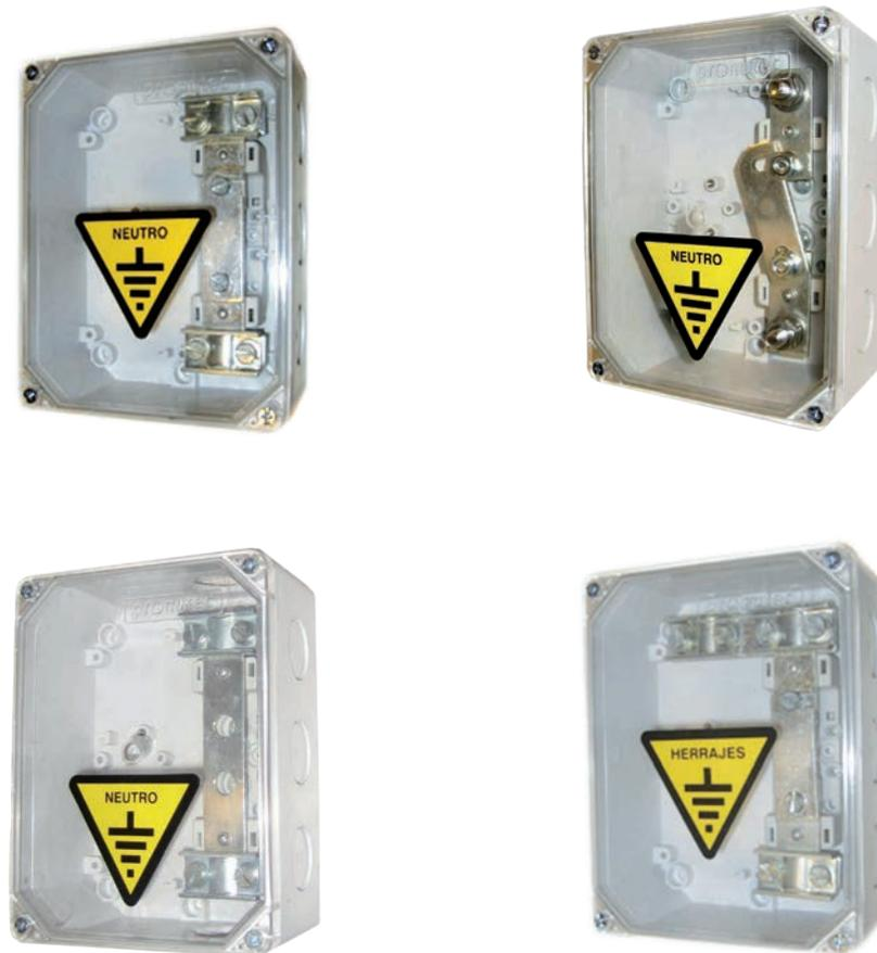
Las **Cajas de Seccionamiento de Tierras** son cajas que permiten efectuar la conexión a tierra de herrajes y de neutro de manera aislada al resto de la instalación. Van colocadas dentro de los centros de transformación.
