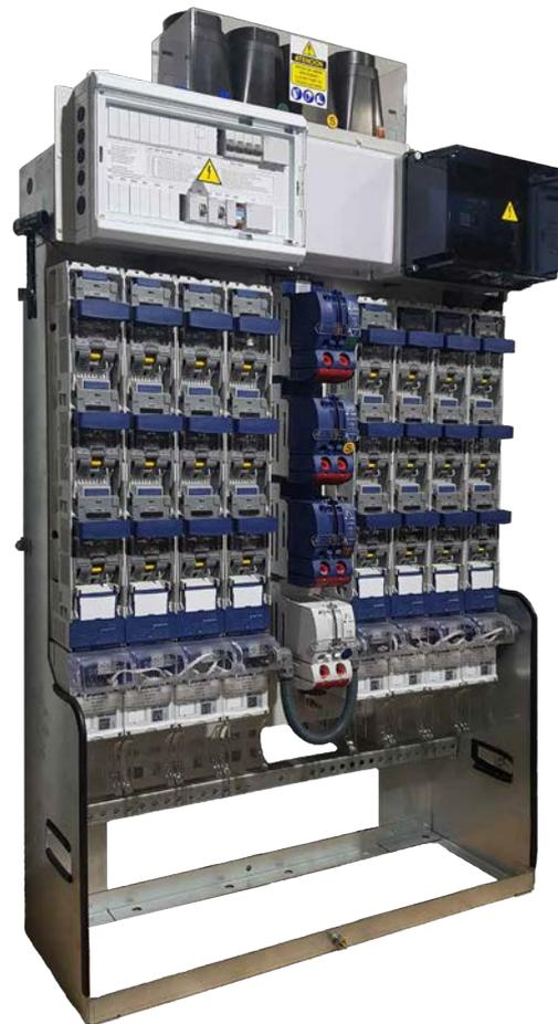
Los **CBTO AC5 y AC8** son los encargados de repartir la salida del transformador en un número de salidas protegidas e independientes mediante bases portafusibles TRIVER+ en la red de distribución de Baja Tensión. La acometida está diseñada para un máximo de 4 cables de 240 mm<sup>2</sup> por fase y 3 cables de 240 mm<sup>2</sup> para el neutro.
